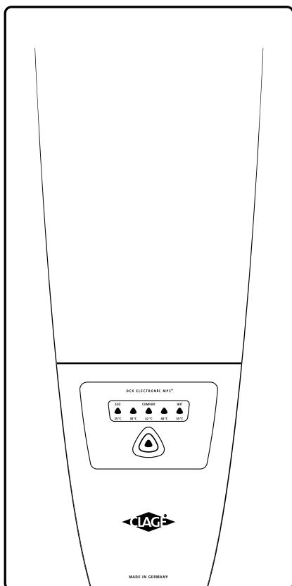
Przepływowy podgrzewacz wody DCX / DCX 13 to sterowany przez mikroprocesor, ciśnieniowy przepływowy podgrzewacz do zdecentralizowanego dostarczania wody do jednego lub wielu punktów jej poboru.
