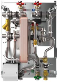
Die WS-GTES-Smart-HT Gasthermenersatzstation ist für den Austausch von Kombi-Gasthermen in Bestandsbauten gedacht. Durch die fast identische Anordnung der Trinkwasseranschlüsse an der Station, ist ein Austausch und der Neuanschluss durch hochwertige, flexible Anschlusschläuche und weiterem Zubehör leicht und schnell realisierbar.
