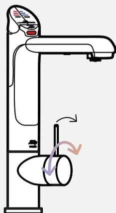
Ziehen Sie den Hebel zur Seite, um das Ventil zu öffnen.
