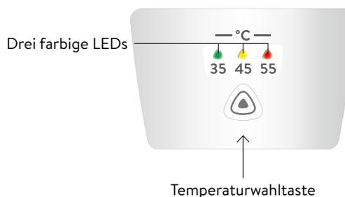
Tastenbedienfeld zur Temperaturwahl. Per Tastendruck kann die jeweils nächste Temperatur gewählt werden (35 °C, 45 °C oder 55 °C).
