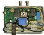
Die Elektronik mit Durchflusserkennung und Temperaturfühler regelt die Leistungsaufnahme, um die eingestellte Auslauftemperatur nicht zu überschreiten.
