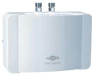
Elektronisch gesteuerter Klein-Durchlauferhitzer mit effektivem Blankdraht-Heizsystem zur wirtschaftlichen Warmwasserversorgung eines Handwaschbeckens. Das kleine, formschöne Gerät erhitzt das Wasser direkt während des Durchströmens, ohne Bereitschaftsenergie zu verbrauchen. Die Elektronik regelt automatisch die Leistung, um die Auslauftemperatur (Werkseinstellung ca. 38 °C) nicht zu überschreiten. Zusammen mit dem sparsam justierten Durchfluss garantiert das Gerät maximale Wirtschaftlichkeit.
