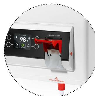
Der Auslass des Kochendwasserautomaten muss sich über dem Spülbecken oder dem Tropfblech befinden. Die Unterkante des Auslasses sollte nicht weniger als 200 mm über dem Tropfblech liegen. Wenn größere Gefäße befüllt werden sollen, muss der Abstand vergrößert werden.
