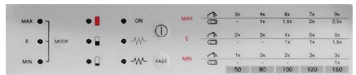
Das moderne Tastenbedienfeld ist komfortabel und informativ. Die Temperatur kann auf 40 °C, 60 °C oder 85 °C eingestellt werden. Über die Wärmehaltsanzeige mit Nutzungstabelle ist leicht zu erkennen, welche Mischwassermenge zur Verfügung steht. Weitere Tasten: Ein-/Ausschalter und Schnellaufheiztaste.
