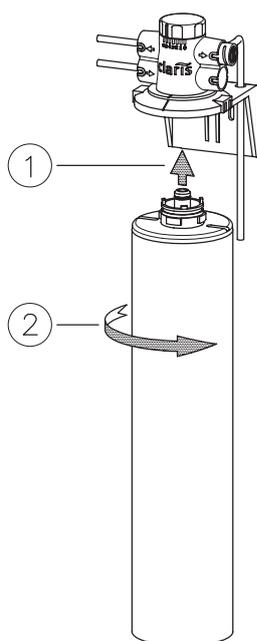
1. Entfernen Sie die Brücke zwischen den Anschlüssen »zu Zubehör« und »von Zubehör« am Untertischgerät.
