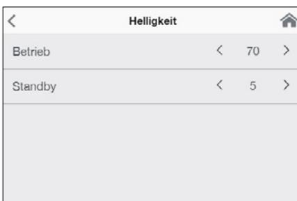
**Helligkeit:** Sie können die Displayhelligkeit verringern z.B. um Strom zu sparen. Die Helligkeit kann für den normalen Betrieb und den Standbymodus separat eingestellt werden.
