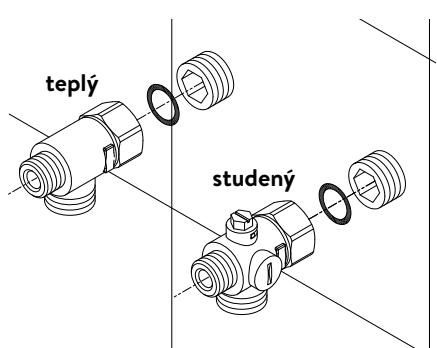
**Nainštalujte vodovodné armatúry**
