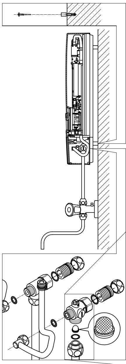
**Remarque : Serrez les écrous d'accouplement avec modération, de manière à obtenir l'étanchéité nécessaire sans endommager les éléments de robinetterie ni les conduites.**
