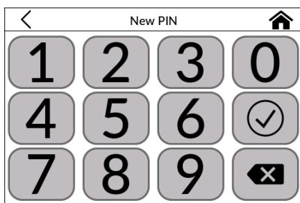
**Introducir PIN:** Se pueden seleccionar hasta 8 dígitos del 0 al 9 utilizando el teclado. Si ha seleccionado cuatro dígitos, confirme la selección pulsando sobre . A continuación, puede elegir entre las tres opciones de bloqueo: parámetro, menú o funcionamiento. Para su activación, es necesario introducir el PIN y confirmarlo de nuevo por motivos de seguridad.
