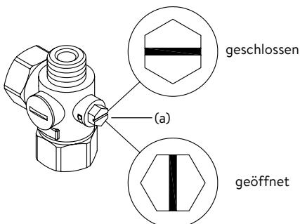
4. Öffnen Sie die Wasserzuleitung und drehen Sie das Absperrenventil (a) im Kaltwasseranschlussstück langsam auf (Position »geöffnet«). Prüfen Sie alle Verbindungen auf Dichtigkeit.
