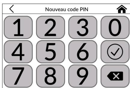
**Saisir le code PIN:** le clavier permet de sélectionner jusqu'à 8 chiffres de 0 à 9. Si vous avez sélectionné quatre chiffres, confirmez en appuyant sur . Ensuite, vous pouvez choisir entre les trois options de verrouillage Paramètres, Menu ou Utilisation. Pour l'activation, le code PIN doit être à nouveau saisi et confirmé pour des raisons de sécurité.
