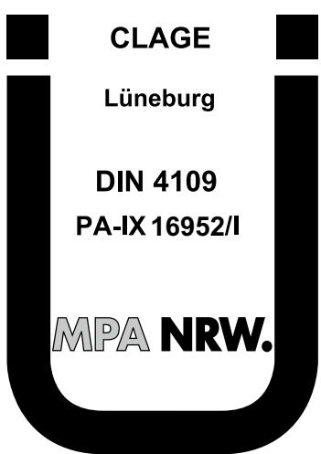
Pro tento přístroj je z důvodu zemských stavebních řádů podána žádost o osvědčení o kontrole stavebního dozoru jako potvrzení o použitelnosti z hlediska hlučnosti.
