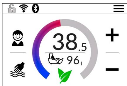
Zatvaranjem i otvaranjem slavine se funkcija pauzira ili ponov pokreće. Funkcija se odmah pokreće ukoliko dolazi do puštanja tople vode u vreme kada se funkcija aktivira. Da prekinete funkciju potrebno je da dodirnete polje količine u trajanju od tri sekunde ili da jedan minut zaustavite protok vode.
