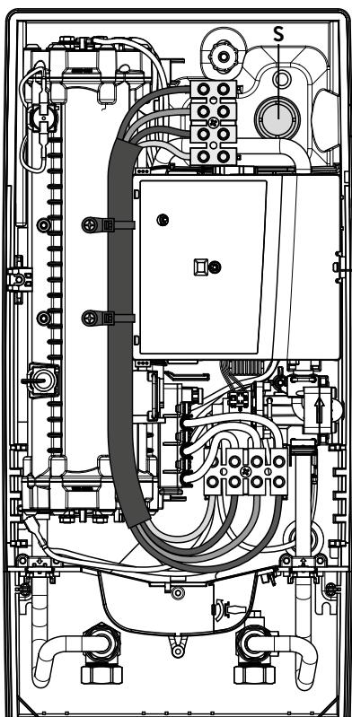
1. Vylomte průchodku (S) v horní části přístroje na prolisu silným tlakem tupým předmětem (např. šroubovákem). U elektrického kabelu připojky uloženého na omítce otevřete prolomení na pravé straně spodní části krytu.
