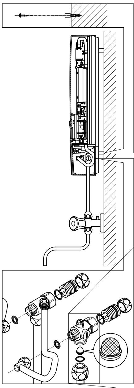
**Hinweis: Ziehen Sie die Überwurfmuttern maßvoll an, um die notwendige Dichtheit zu erreichen, ohne die Armaturen oder die Rohrleitungen zu beschädigen.**
