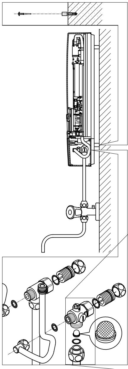
**Nota: aperte as porcas de união moderadamente para obter o aperto necessário sem danificar os encaixes ou a tubagem.**
