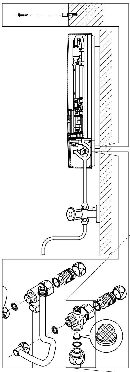
**Примечание: затягивайте накидные гайки с осторожностью, чтобы обеспечить необходимую герметичность, не повреждая фитинги и трубопроводы.**
