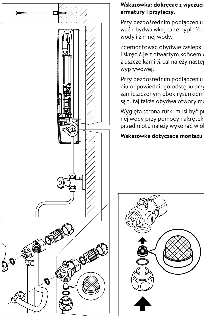
**Wskazówka: dokręcać z wyczuciem nakrętki, aby uzyskać szczelność, nie uszkadzając armatury i przyłączy.**
