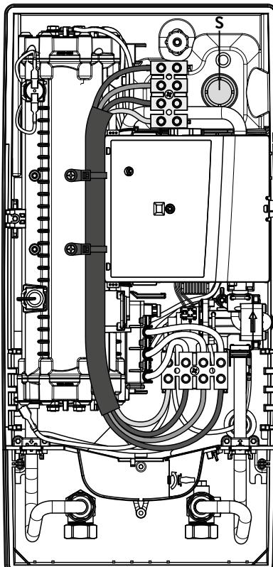
1. Otvorite postojeće mesto za probijanje otvora na gornjem delu uređaja (S) po perforaciji snažnim pritiskom tupim alatom (npr. odvijačem). Kada je električni priključni kabl postavljen na zidu, dodatno otvorite otvor na desnoj strani donjeg dela uređaja.
