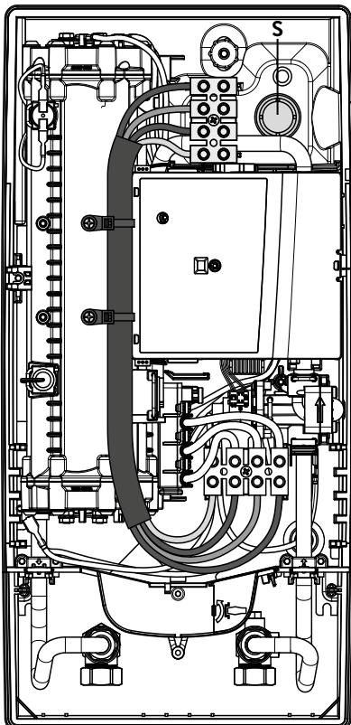
**Hinweis:** Um den IP25 Spritzwasserschutz zu gewährleisten, muss die Spritzwasserschutztülle unten am Gerät eingesetzt bleiben.
