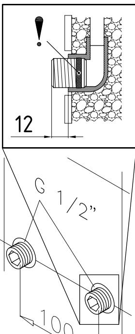
1. Завийте завинтващите нипели с 12 mm ключ с вътрешен шестостен в двете връзки за водата. При това уплътненията трябва да са изцяло завити в резбата. Сърчащата част на завинтващите нипели след затягането трябва да е 12 – 14 mm.
