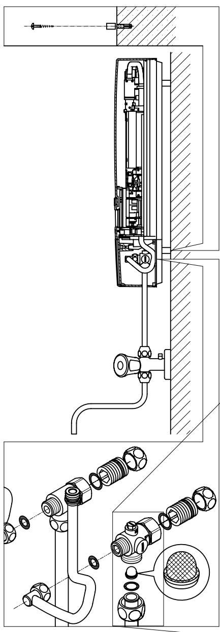
**Upozornenie: Mierne dotiahnite prevlečné matice, aby ste dosiahli potrebnú tesnosť bez poškodenia armatúr alebo potrubí.**
