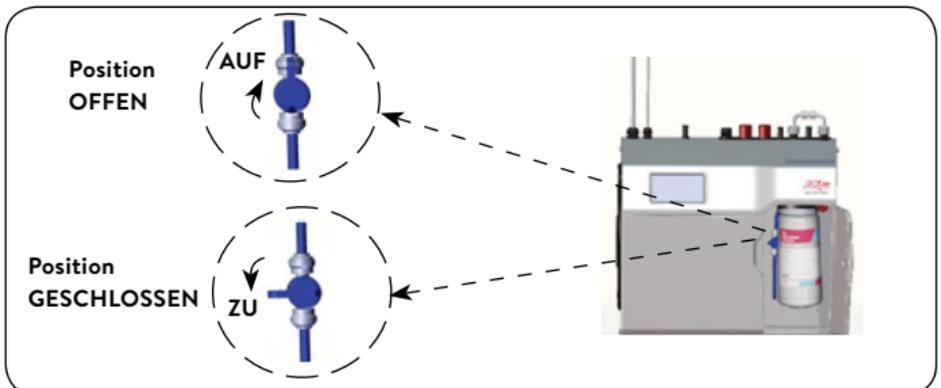
**Hinweis:** Um alle abgelagerten Ruß-Partikel (diese sind normal) aus dem Filter zu spülen, sollten Sie mindestens 10l Wasser durch den Filter laufen lassen.
