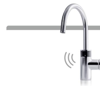
> Mitigeur évier automatique monocommande avec poigné latéral et déclenchement infrarouge, réglage de la température sans graduation par poigné latéral, possibilité d'activer la fonction rinçage hygiénique (rinçage automatique toutes les 12 ou 24 heures), réglage du temps d'écoulement de l'eau, saillie 21 cm
