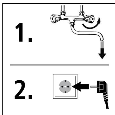
1. Warmwaterkraan openen of eengreeps mengkraan op »warm« zetten tot er geen luchtbellen meer in het water zitten.
