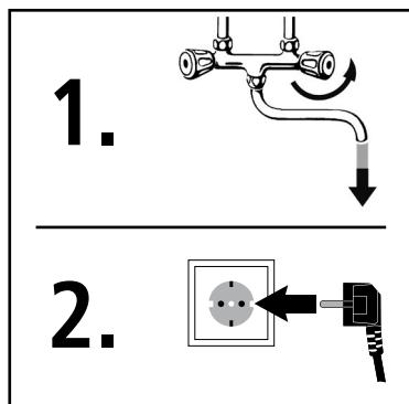
1. Otevřít teplovodní ventil armatury a nastavit jednoruční směšovací baterii do polohy „teplá voda“ a vyčkat, až odtékající voda začne vytékat bez bublin.
