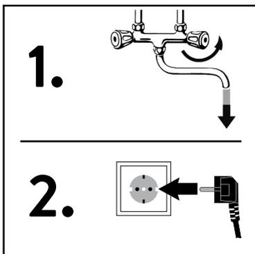
1. Otworzyć zawór ciepłej wody albo w przypadku baterii jednouchwytowych ustawić w pozycji na „ciepłą wodę“ i spuszczać wodę tak długo, aż znikną pęcherze powietrza.
