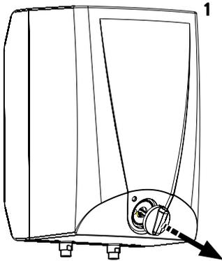
**Pro otevření pláště přístroje**
