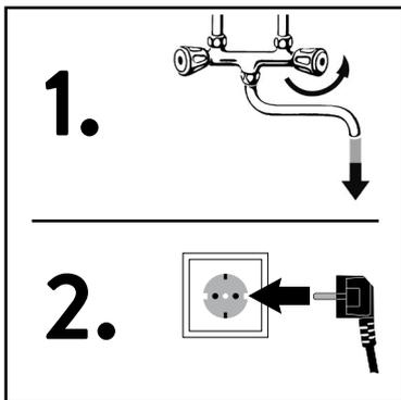
1. Ouvrir la vanne d'eau chaude de la robinetterie ou positionner le mitigeur sur « chaud » jusqu'à ce qu'il n'y a plus de bulles d'air dans l'eau qui s'écoule.
