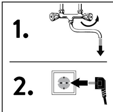
1. Warmwaterkraan openen of eengreeps mengkraan op »warm« zetten tot er geen luchtballen meer in het water zitten.
