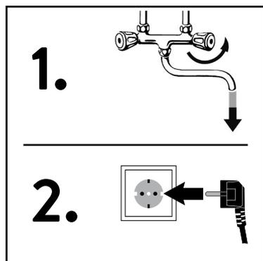
1. Otevřít teplovodní ventil armatury anebo nastavit jednoruční směšovací baterii do polohy „teplá voda“ a vyčkat, až odtékající voda začne vytékat bez bublin.
