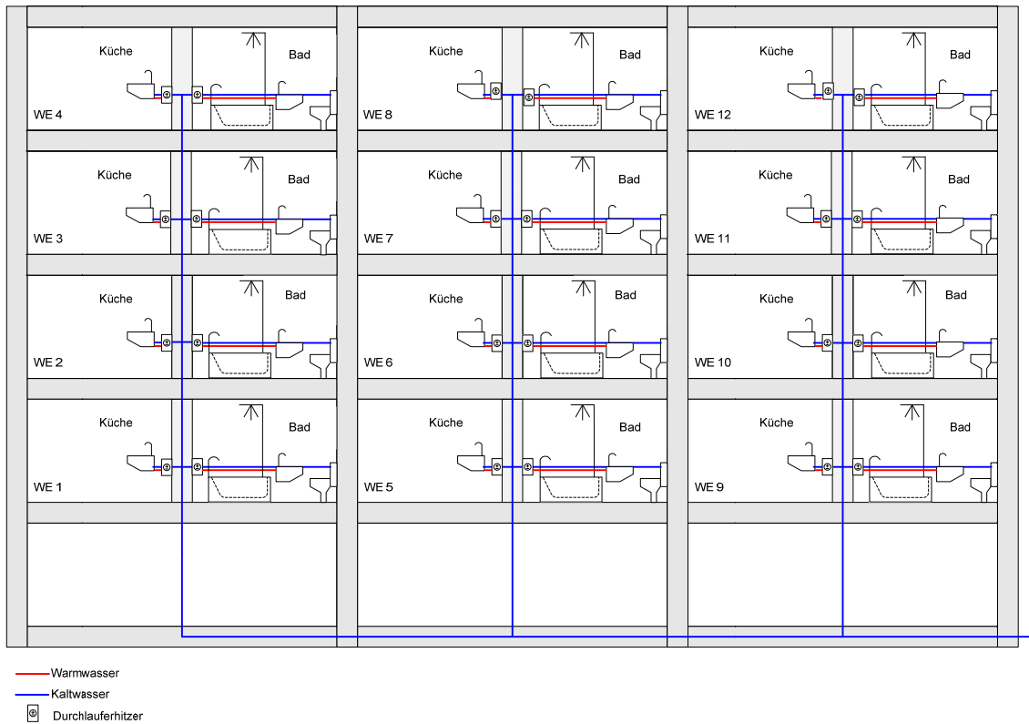
Abbildung 5-6: Schematische Darstellung der dezentralen WW-Versorgung des 12FH
